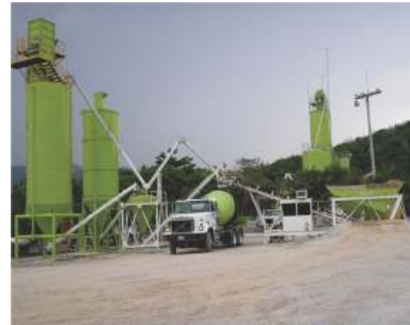
Figura 3 – Planta móvil de concreto dosificadora
