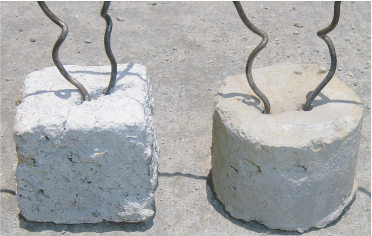
En este orden de ideas el recubrimiento del acero de refuerzo está directamente relacionado con la durabilidad de la estructura. La durabilidad según la norma ACI se define como la habilidad que tiene la estructura para resistir la acción del intemperismo, ataque químico, abrasión o cualquier otro proceso de deterioro.
